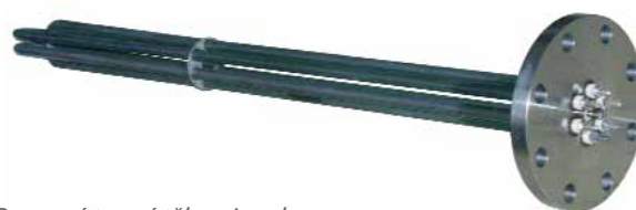
Ponorné topné těleso je vybaveno distančním třmenem, který fixuje polohu spirál. Fotografie: ponorné topné těleso 30 kW, délka LT pod přírubou: 900 mm
